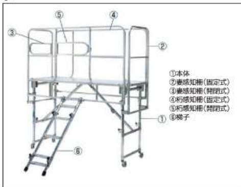
感知柵は作業床に引っ掛けて脚柱に固定するだけ
